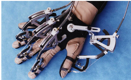
Abb. 6: Der CyberGrasp als Beispiel für ein Exoskelett (aus: Virtex, 1998).
