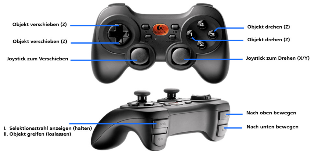
Abb. 5: Das cordless Logitech Rumblepad 2 mit den Erklärungen der Tastenbelegung zur Steuerung im virtuellen Basisszenario.
