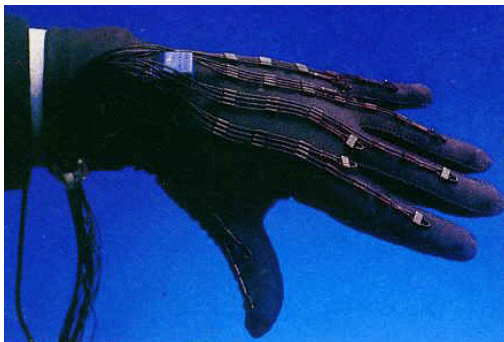
Abb. 4: Links: Beispiel für einen Datenhandschuh. Rechts: Technischer Aufbau des Datenhandschuhs (aus Schnurr, 2003).
