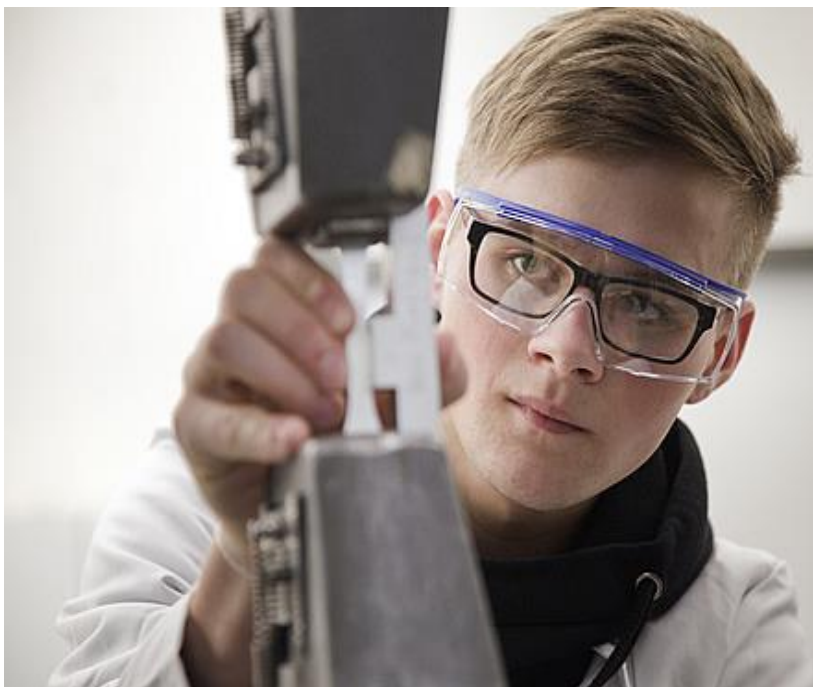
Abb. 1: Technisches Experimentieren als Grundlage für die Untersuchung von Werkstoffeigenschaften: Werkstoffprüfer beim Zugversuch (Bundesagentur für Arbeit, 2013)
